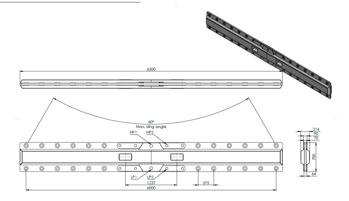
Lifting Beam Koppelbaar 50T - 6m Type: EVK5060.02.01 Weight: 1937 KG WLL: 50T
